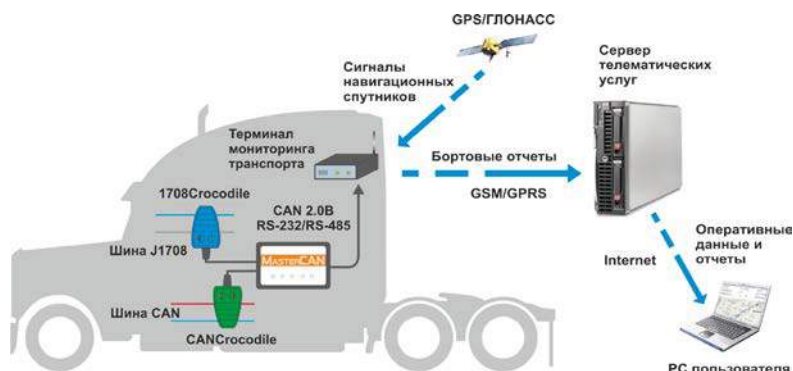
а) для интеграции бортовых информационных шин CAN и J1708 с системой транспортной телематики
