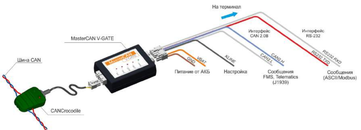
Рисунок А.3 — Получение телематической информации из бортовой шины CAN по интерфейсам CAN 2.0B и RS-232
