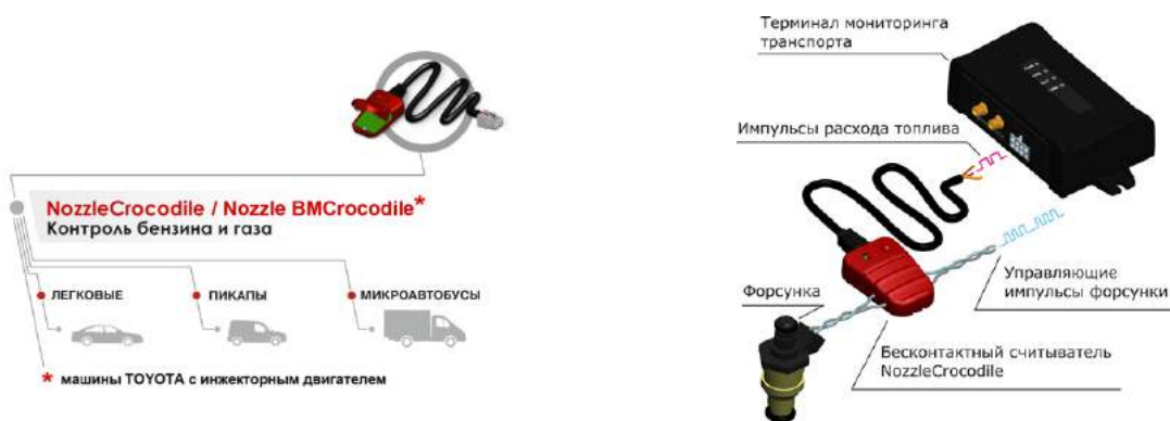
б) при помощи NozzleCrocodile/Nozzle BMCrocodile
