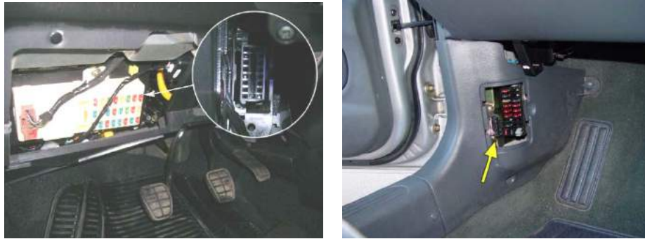
Рисунок 10 — Примеры расположения диагностического разъема OBD II в кабине ТС
