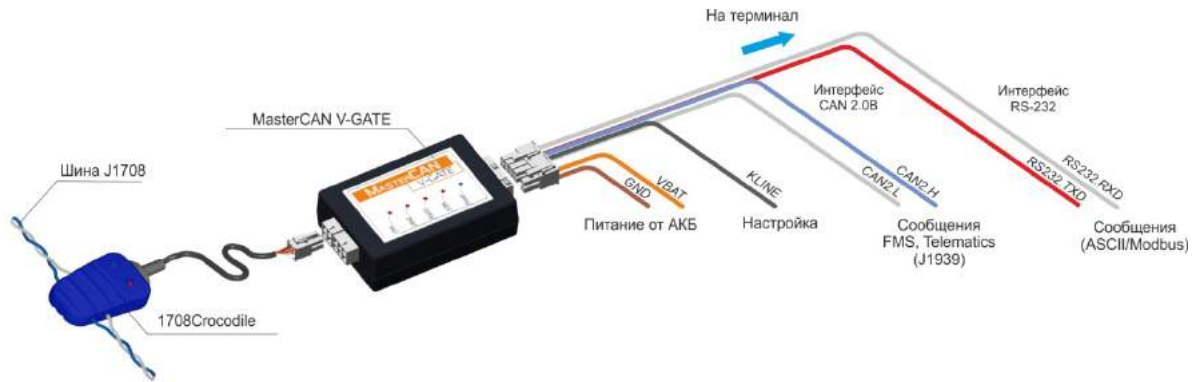
Рисунок А.4 — Получение телематической информации из бортовой шины J1708 по интерфейсам CAN 2.0B и RS-232
