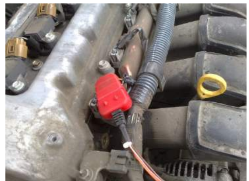
Рисунок 16 — Примеры подключения Crocodile к проводам ТС
