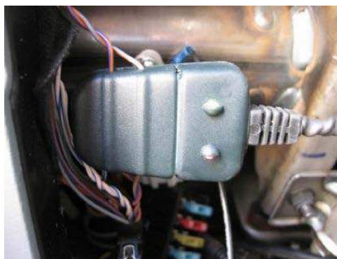
Рисунок 16 — Примеры подключения Crocodile к проводам ТС
