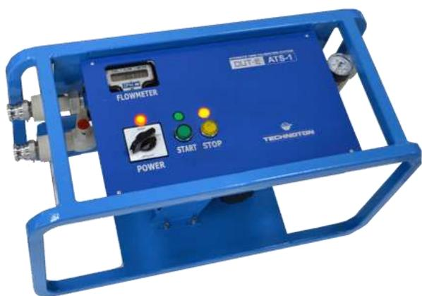
Тарировочная станция DUT-E ATS-1 предназначена для автоматической тарировки топливных баков автомобилей и других транспортных средств, а также для стационарных емкостей до 3000 литров, в которые установлен датчик уровня топлива. Управление осуществляется с Android-устройства по Bluetooth. Станция позволяет сократить время тарировки бака в 2-3 раза и выполнить тарировку бака с более высокой точностью.
