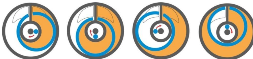
Рисунок 9 — Схема работы измерительной камеры DFM Marine
