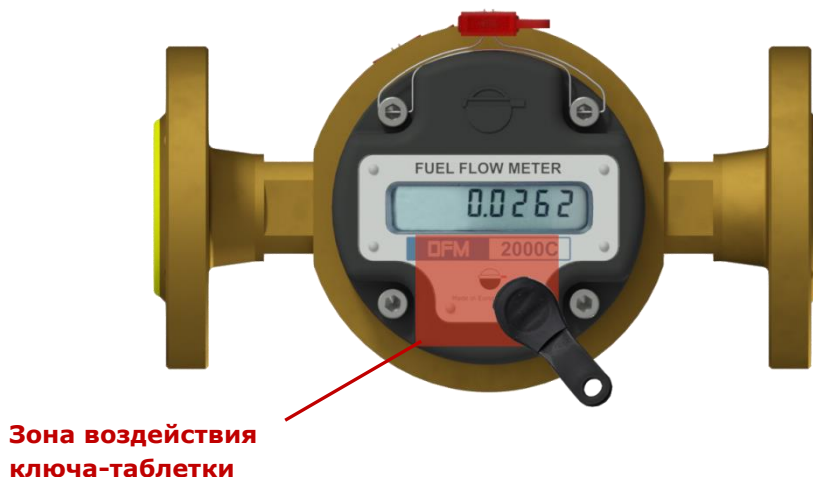
Рисунок 10 — Переключение информационных экранов дисплея DFM Marine
