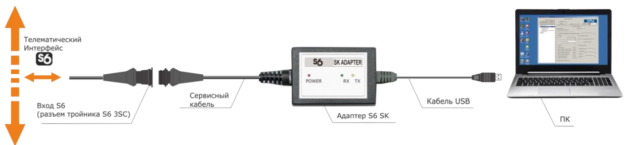
а) при настройке DFM Marine с помощью S6 SK в составе Телематического интерфейса S6
