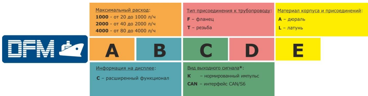
Рисунок 1 — Условное обозначение расходомеров топлива DFM Marine для заказа
