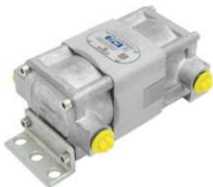
**Дифференциальные** (модели DFM 100DS7, DFM 250DS7, DFM 500DS7) — измеряют расход топлива как разницу расходов (поток) топлива в подающей и обратной магистралях топливной системы — дифференциальный расход от 10 до 600 л/ч. Устанавливаются на автотракторную, водную, железнодорожную и специальную технику либо стационарные агрегаты с современными дизельными двигателями, которые оснащены системами впрыска топлива Common Rail либо насос-форсунками.
