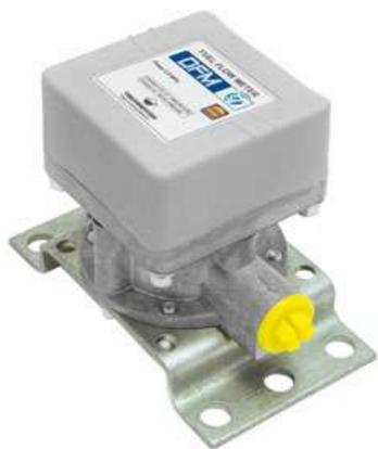
**Однокамерные** (модели DFM 50S7, DFM 100S7, DFM 250S7, DFM 500S7) — измеряют расход топлива, протекающего по подающей топливной магистрали потребителя. Могут работать как автономно, так и в составе системы телематики. Предназначены для контроля расхода топлива автотракторной, строительной, железнодорожной, водной и стационарной техники с двигателями Евро-4 и ниже, где разрешено производить модификацию топливной системы. Диапазон измерения расхода топлива от 1 до 500 л/ч.
